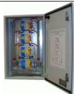
ЩЗИП® с установленными УЗИП класса I и II для защиты трехфазной электроустановки переменного тока, воздушная линия питания, система заземления типа TN-S,  $U_N = 380$  В,  $I_N = 63$  А. Ввод-вывод снизу. Подключение в разрыв линии питания. 600\*400\*150 мм. IP65. УХЛ1.
