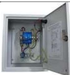
ЩЗИП® с установленным УЗИП класса I+II для защиты однофазной электроустановки переменного тока, кабельная линия питания, система заземления типа TN-S,  $U_N = 230$  В,  $I_N = 32$  А. Ввод снизу. Подключение параллельно защищаемой нагрузке. Световая сигнализация о выходе из строя УЗИП на дверце шкафа. Для
