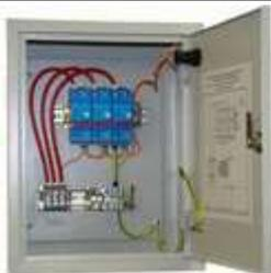
ЩЗИП® с установленным УЗИП класса I+II для защиты трехфазной электроустановки переменного тока, кабельная линия питания, система заземления типа TN-C,  $U_N = 380$  В, до  $I_N = 315$  А. Ввод снизу. Подключение параллельно защищаемой нагрузке. Световая сигнализация о выходе из строя УЗИП на дверце шкафа. 400\*300\*150 мм. IP30. УХЛ4.
