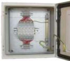
ЩЗИП®-ТМ для защиты 5-ти двухпроводных линий передачи данных, управления, контроля и измерения. Подключение проводников защищаемых линий на дополнительные клеммы. Ввод снизу-вывод сверху. 300\*300\*150 мм. IP55. УХЛ3
