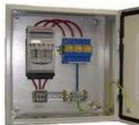
ЩЗИП® с установленными УЗИП класса I для защиты трехфазной электроустановки переменного тока, воздушная линия питания, система заземления типа TN-C,  $U_N = 380$  В,  $I_N = 160$  А. Ввод снизу. Подключение параллельно защищаемой нагрузке. 300\*300\*150 мм. IP55. УХЛЗ. Для защиты УЗИП от тока короткого замыкания установлены предохранители 160 А помещенные в ПВР.
