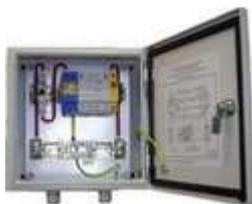
ЩЗИП® с установленными УЗИП класса I и II для защиты однофазной электроустановки переменного тока, воздушная линия питания, система заземления типа TN-C,  $U_N = 230$  В,  $I_N = 63$  А. Ввод-вывод снизу. Подключение в разрыв линии питания. Автоматический выключатель на 63 А предназначен для защиты всей электроустановки от токов короткого замыкания. 300\*300\*150 мм. IP55. УХЛЗ\*
