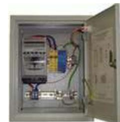
ЩЗИП® с установленными УЗИП класса II для защиты электроустановки постоянного тока, кабельная линия питания, система заземления типа TN-S,  $U_N = 220$  В DC,  $I_N = 100$  А. Ввод снизу. Подключение ЩЗИП® параллельно защищаемой нагрузке. Световая сигнализация о выходе из строя УЗИП на дверце шкафа. 400\*300\*150 мм. IP30. УХЛ4. Для защиты УЗИП от тока короткого замыкания установлены предохранители 100 А gG, помещенные в ПВР.
