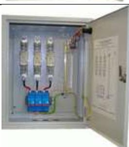
ЩЗИП® с установленным УЗИП класса I+II для защиты трехфазной электроустановки переменного тока, кабельная линия питания, система заземления типа TN-C,  $U_N = 380$  В,  $I_N = 250$  А. Ввод сверху. Подключение параллельно защищаемой нагрузке. Световая сигнализация о выходе из строя УЗИП на дверце шкафа. Для защиты УЗИП от тока короткого замыкания установлены предохранители 250 А gG. 400\*300\*150 мм. IP30. УХЛ4
