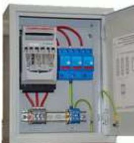
ЩЗИП® с установленным УЗИП класса I+II для защиты трехфазной электроустановки переменного тока, кабельная линия питания, система заземления типа TN-C,  $U_N = 380$  В,  $I_N = 100$  А. Ввод снизу. Подключение параллельно защищаемой нагрузке. Для защиты УЗИП от тока короткого замыкания установлены предохранители 100 А gG, помещенные в ПВР. 400\*300\*150 мм. IP30. УХЛ4.
