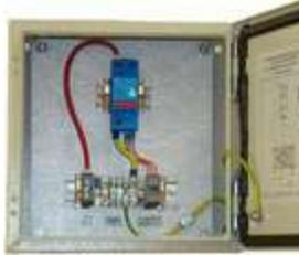
ЩЗИП® с установленным УЗИП класса I+II для защиты однофазной электроустановки переменного тока, кабельная линия питания, система заземления типа TN-C,  $U_N = 230$  В, до  $I_N = 315$  А. Ввод снизу. Подключение параллельно защищаемой нагрузке. Для организации удаленного контроля состояния УЗИП с пульта оператора в ЩЗИП имеются контакты дистанционной сигнализации. 300\*300\*150 мм. IP55. УХЛ3.
