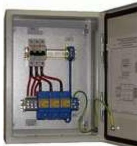
ЩЗИП® с установленными УЗИП класса I для защиты трехфазной электроустановки переменного тока, воздушная линия питания, система заземления типа TN-C,  $U_N = 380$  В,  $I_N = 63$  А. Ввод сверху - вывод снизу. Подключение ЩЗИП® в разрыв линии питания, УЗИП подключаются параллельно защищаемой нагрузке. 400\*300\*150 мм. IP55. УХЛЗ\*. Автоматический выключатель 63 А предназначен для отключения всей электроустановки.
