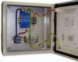
ЩЗИП® с установленным УЗИП класса I+II для защиты электроустановки постоянного тока, кабельная линия питания, система заземления типа TN-S,  $U_N = 48$  В DC,  $I_N$  до 315 А. Ввод снизу. Подключение параллельно защищаемой нагрузке. 300\*300\*150 мм. IP54. УХЛЗ.
