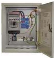
ЩЗИП® с установленными УЗИП класса I для защиты электроустановки постоянного тока, воздушная линия питания, система заземления типа TN-S,  $U_N = 220 \text{ В}$ ,  $I_N = 160 \text{ А}$ . Ввод снизу. Подключение ЩЗИП® параллельно защищаемой нагрузке. Световая сигнализация о выходе из строя УЗИП на дверце шкафа. 400\*300\*150 мм. IP30. УХЛ4. Для защиты УЗИП от тока короткого замыкания установлены предохранители 160 А gG, помещенные в ПВР.
