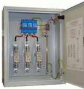
ЩЗИП® с установленным УЗИП класса I+II для защиты трехфазной электроустановки переменного тока, кабельная линия питания, система заземления типа TN-C,  $U_N = 380$  В,  $I_N = 250$  А. Ввод снизу. Подключение параллельно защищаемой нагрузке. Световая сигнализация о выходе из строя УЗИП на дверце шкафа. Для защиты УЗИП от тока короткого замыкания установлены предохранители 250 А gG. 400\*300\*150 мм. IP30. УХЛ4.
