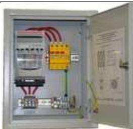
ЩЗИП® с установленным УЗИП класса II для защиты трехфазной электроустановки переменного тока, система заземления типа TN-S,  $U_N = 380$  В,  $I_N = 160$  А. Ввод снизу. Подключение параллельно защищаемой нагрузке. Для защиты УЗИП от тока короткого замыкания установлены предохранители 160 А gG, помещенные в ПВР. 400\*300\*150 мм. IP30. УХЛ4.
