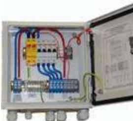
ЩЗИП® с установленным УЗИП класса II для защиты электроустановки постоянного тока, кабельная линия питания, система заземления типа TN-S,  $U = 48$  В DC,  $I_N = 63$  А. Ввод-вывод снизу. Подключение в разрыв линии питания. 300\*300\*150 мм. IP54. УХЛЗ. По требованию заказчика установлены 4-е автоматические выключатели С16 А
