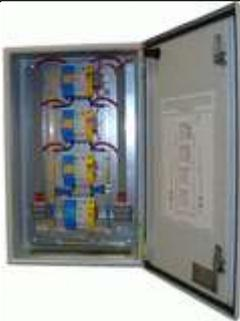
ЩЗИП® с установленными УЗИП класса I и II для защиты трехфазной электроустановки переменного тока, воздушная линия питания, система заземления типа TN-S,  $U_N=380$  В,  $I_N=63$  А. Ввод-вывод снизу. Подключение в разрыв линии питания. 600\*400\*150 мм. IP65. УХЛ1.
