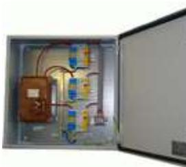
ЩЗИП® с установленными УЗИП класса I и II для защиты трехфазной электроустановки переменного тока, воздушная линия питания, система заземления типа TN-C,  $U_N=380$  В,  $I_N= 63$  А. Ввод-вывод снизу. Подключение в разрыв линии питания. Автоматический выключатель на 63 А предназначен для защиты всей электроустановки от токов короткого замыкания. По техническому заданию заказчика выбран автоматический выключатель с возможностью опечатывавания Энергосбытом. 500\*500\*250 мм. IP65. УХЛ1
