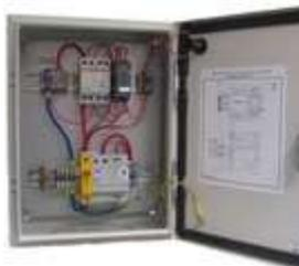
ЩЗИП® с установленным УЗИП класса II и III, реле контроля напряжения и контактором. Предназначен для защиты однофазной электроустановки переменного тока, воздушная или кабельная линия питания, система заземления типа TN-C,  $U_N = 230$  В,  $I_N = 63$  А от импульсных и длительных перенапряжений. Ввод сверху, вывод снизу. Подключение в разрыв питающей сети. Световая сигнализация о срабатывании реле контроля напряжения и выходе из строя УЗИП на дверце шкафа. 400\*300\*150 мм. IP54. УХЛ4
