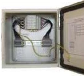
ЩЗИП®-ТМ для защиты 4-х двухпроводных линий передачи данных, управления, контроля и измерения. Подключение проводников защищаемых линий на дополнительные клеммы. Ввод-вывод снизу. 300\*300\*150 мм. IP55. УХЛ3.
