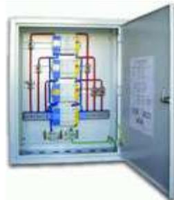
ЩЗИП® с установленными УЗИП класса I и II для защиты трехфазной электроустановки переменного тока, воздушная линия питания, система заземления типа TN-S,  $U_N = 380$  В,  $I_N = 63$  А. Ввод-вывод снизу. Подключение в разрыв линии питания. 600\*500\*150 мм. IP30. УХЛ4. По техническому заданию заказчика добавлено два комплекта клемм для подключения дополнительных линий питания.
