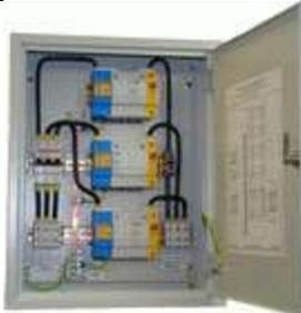
ЩЗИП® с установленными УЗИП класса I и II для защиты трехфазной электроустановки переменного тока, воздушная линия питания, система заземления типа TN-C,  $U_N=380$  В,  $I_N= 63$  А. Ввод-вывод снизу. Подключение в разрыв линии питания. Автоматический выключатель на 63 А предназначен для защиты всей электроустановки от токов короткого замыкания. 500\*400\*150 мм. IP30. УХЛ4
