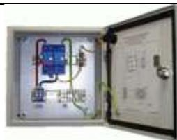
ЩЗИП® с установленным УЗИП класса I+II для защиты однофазной электроустановки переменного тока, кабельная линия питания, система заземления типа TN-S,  $U_N = 230$  В, до  $I_N = 315$  А. Ввод снизу. Подключение параллельно защищаемой нагрузке. Световая
