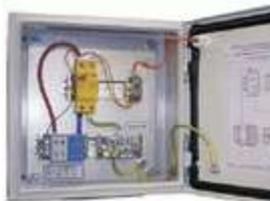
ЩЗИП® с установленным УЗИП класса II для защиты электроустановки постоянного тока, кабельная линия питания, система заземления типа TN-S,  $U_N = 48$  В DC,  $I_N$  до 160 А. Ввод снизу. Подключение параллельно защищаемой нагрузке. 300\*300\*150 мм. IP54. УХЛЗ. По требованию заказчика установлены клеммы Ensto
