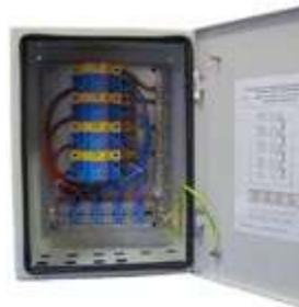
ЩЗИП® с установленным УЗИП класса I+II для защиты 4-х фидерной электроустановки постоянного тока, кабельная линия питания, система заземления типа TN-S,  $U_N = \pm 48\text{В}$ ,  $I_N = 30\text{А}$ . Ввод-вывод снизу. Подключение в разрыв питающей линии. 400\*300\*210 мм. IP66. УХЛ1.
