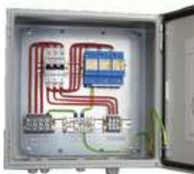
ЩЗИП® с установленными УЗИП класса I для защиты трехфазной электроустановки переменного тока, воздушная линия питания, система заземления типа TN-C,  $U_N = 380$  В,  $I_N = 32$  А. Ввод - вывод снизу. Подключение ЩЗИП® в разрыв линии питания, УЗИП подключаются параллельно защищаемой нагрузке. 300\*300\*150 мм. IP55. УХЛЗ\*. Автоматический выключатель 32А предназначен для отключения всей электроустановки.
