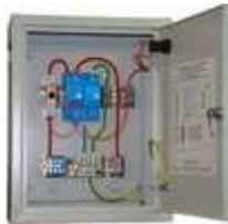
ЩЗИП® с установленным УЗИП класса I+II для защиты однофазной электроустановки переменного тока, кабельная линия питания, система заземления типа TN-S,  $U_N = 230$  В,  $I_N = 32$  А. Ввод-вывод снизу. Подключение в разрыв питающей сети. Световая сигнализация о выходе из строя УЗИП на дверце шкафа. Автоматический выключатель на 32 А предназначен для защиты всей электроустановки от токов короткого замыкания. 400\*300\*150 мм. IP30. УХЛ4.
