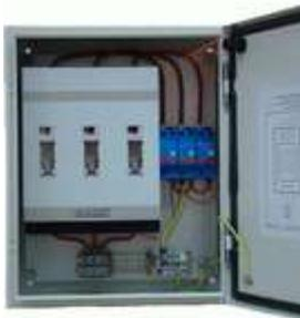
ЩЗИП® с установленным УЗИП класса I+II для защиты трехфазной электроустановки переменного тока, кабельная линия питания, система заземления типа TN-C,  $U_N = 380$  В,  $I_N = 315$  А. Ввод снизу. Подключение параллельно защищаемой нагрузке. Световая сигнализация о выходе из строя УЗИП на дверце шкафа. Для защиты УЗИП от тока короткого замыкания установлены предохранители 315 А gG, помещенные в ПВР. 500\*400\*150 мм. IP55. УХЛ3
