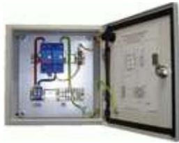
ЩЗИП® с установленным УЗИП класса I+II для защиты однофазной электроустановки переменного тока, кабельная линия питания, система заземления типа TN-S,  $U_N = 230$  В, до  $I_N = 315$  А. Ввод снизу. Подключение параллельно защищаемой нагрузке. Световая сигнализация о выходе из строя УЗИП на дверце шкафа. 300\*300\*150 мм. IP55. УХЛ3.
