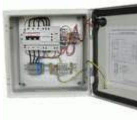
ЩЗИП® с установленным УЗИП класса III для защиты трехфазной электроустановки переменного тока, система заземления типа TN-S,  $U_N = 380$  В,  $I_N = 16$  А. Ввод снизу. Подключение параллельно защищаемой нагрузке. Для защиты УЗИП от тока короткого замыкания установлен автоматический выключатель С16 А. Световая сигнализация о выходе из строя УЗИП на дверце шкафа. 300\*300\*150 мм. IP54. УХЛ3\*
